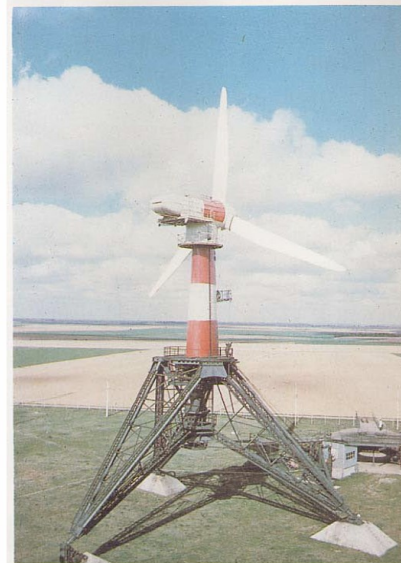
Aérogénérateur Best Romani de 800 kW expérimenté par EDF à Nogent-le-Roi. (photo EDF).
